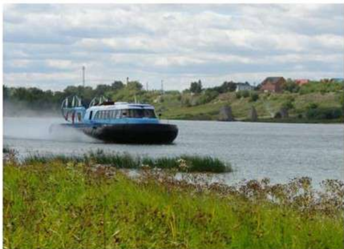
Фото 2. «Арктика-3ДК». Ходовые испытания в пойме р. Иртыш.
