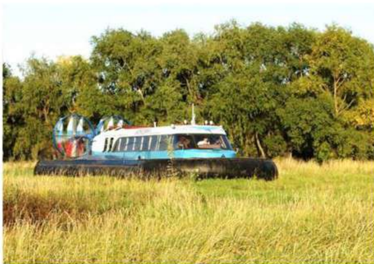
Фото 3. «Арктика-3ДК». Испытания на заболоченном грунте.
